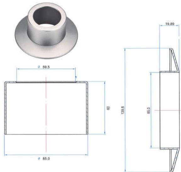
Bereits vorhandene, verchromte Rosetten von Supercom 281 und Wasserzählern mit Supercom 581 / 587 können weiter verwendet werden. Aufgrund des hohen Chromanteils ist jedoch mit einer verminderten Funkreichweite zu rechnen. Bestehende originale Rosetten von Minol und Techem können nicht verwendet werden.
