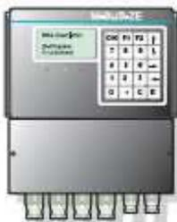
Per il rilevamento automatico dei dati attraverso il sistema M-BUS, viene impiegata una centralina a microprocessore, che in esecuzione standard, viene fornita con 256 kB di memoria interna, una tastiera „a tatto“ e un display a cristalli liquidi. Per piccoli impianti M-BUS è disponibile una centralina in versione „mini ZE“ per un massimo di 60 oppure 20 contatori M-BUS. Le centraline „mini ZE“ sono equipaggiate per la lettura dei dati diretta oppure attraverso la porta seriale RS-232 con un PC.
