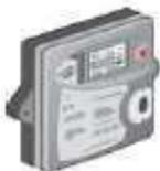
Il contatore di calore „split“ MEGACONTROL CF51, è fornito con sensori di portata ad ultrasuoni per portate nominali da 0,6 a 40 m<sup>3</sup>/h oppure con misuratori di portata meccanici da Qn 60 a Qn 250 m<sup>3</sup>/h. La centralina è adatta per un campo di temperatura da 0 a 180° C e può essere equipaggiata anche in un secondo momento con le schede interfaccia per la teletrasmissione dati e M-BUS.
